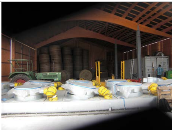
Abb. 2c: Rundballentrockner der Fa. LASCO Heu Technik GmbH mit 20 Trocknungsplätzen.
