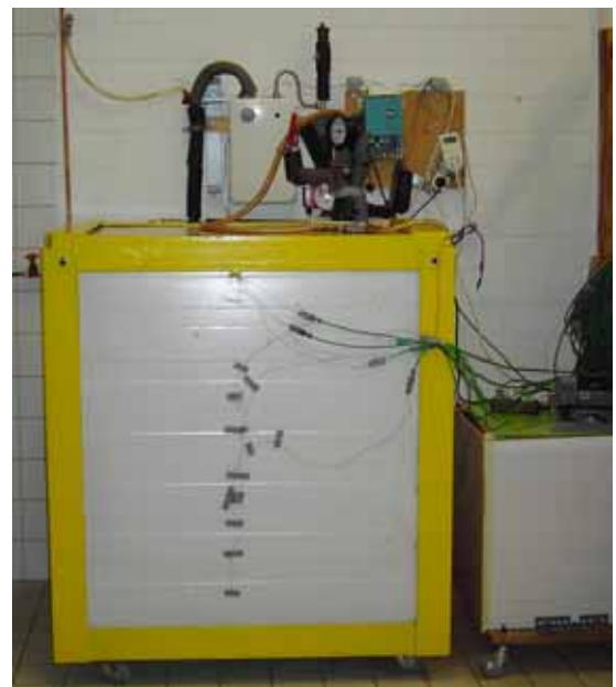
Abb. 1: Labor-Prototyp des modularen Speichers, aus /Wilh05/
